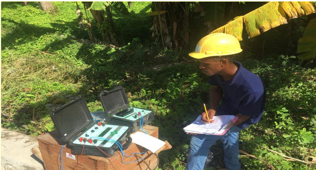
FIGURE 5 : Georésistivimètre PASI 16GL-N mise en place suivant la dispositif de Schlumberger
